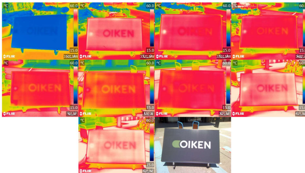
Photographie 5 : Évolution de la température de surface du panneau PV avec motif du logo de OIKEN. Au pied du bâtiment 23.
