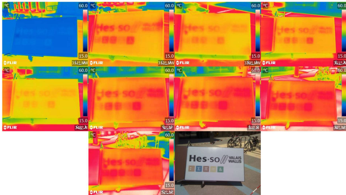
Photographie 4 : Évolution de la température de surface du panneau PV avec motif du logo de la HES-SO. Au pied du bâtiment 23.
