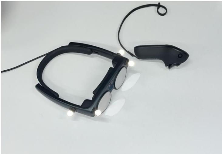
*Note.* Les lunettes de réalité augmentée Magicleap 2 permettent d'afficher les cibles. La manette permet de pouvoir parcourir le casque de réalité augmentée.
