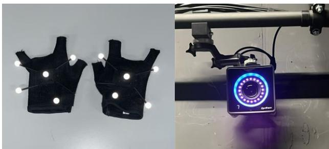
*Note.* Les gants, à gauche, étaient placés sur les mains des participants. Les caméras OptiTrack, à droite permettent de capturer et d'enregistrer les mouvements.
