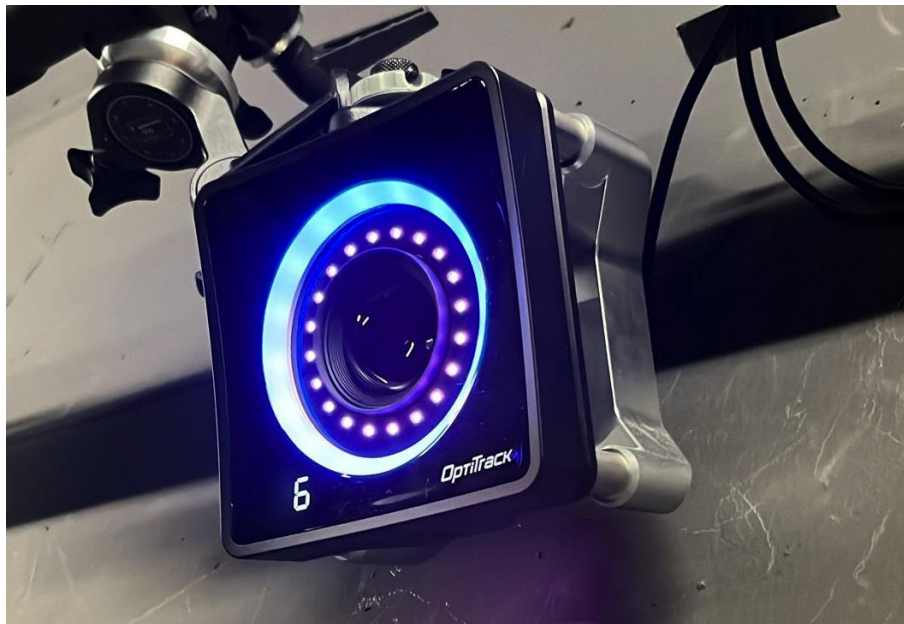
Caméra infrarouge PrimeX 22
