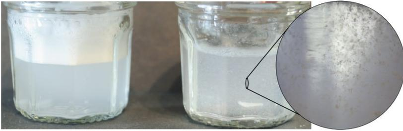
**Abb. 3** Schaumverhalten von entionisiertem Wasser (Links) und stillem Mineralwasser (rechts) mit Kernseife
