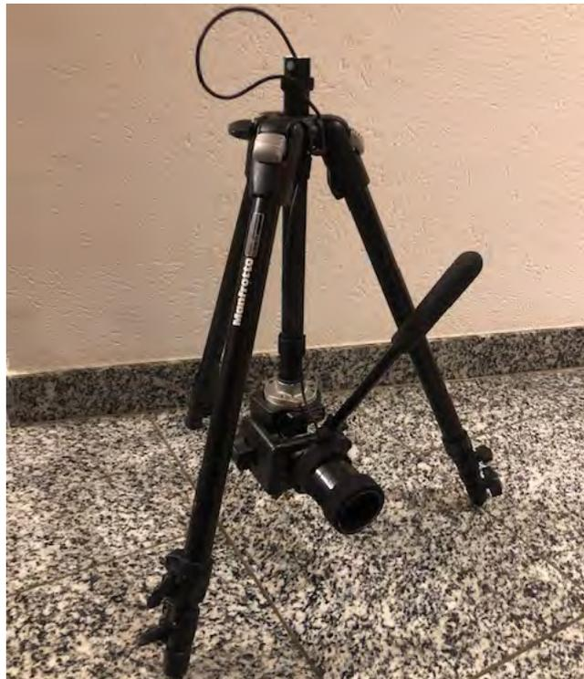
*Note.* La figure montre l'équipement dans lequel le lidar a été incorporé. Le Lidar était situé dans le tube au milieu de trois pieds d'appui. Cet appareil lors du a penalty permettait de détecter la distance du ballon dès qu'il a été frappé (CopeLab, 2022).
