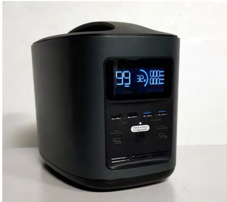
*Note.* Centrale électrique (EcoFlow River) qui a permis de fournir une énergie suffisante à tous les appareils pour la récolte des données. Au centre est présent l'écran centrale avec les indications de l'autonomie restante. De plus il est munie de deux prises 230 Volts, quatre ports USB et de deux prises pour charger des éléments (téléphone mobile ; casque) demandant moins d'intensité (CopeLab, 2021).
