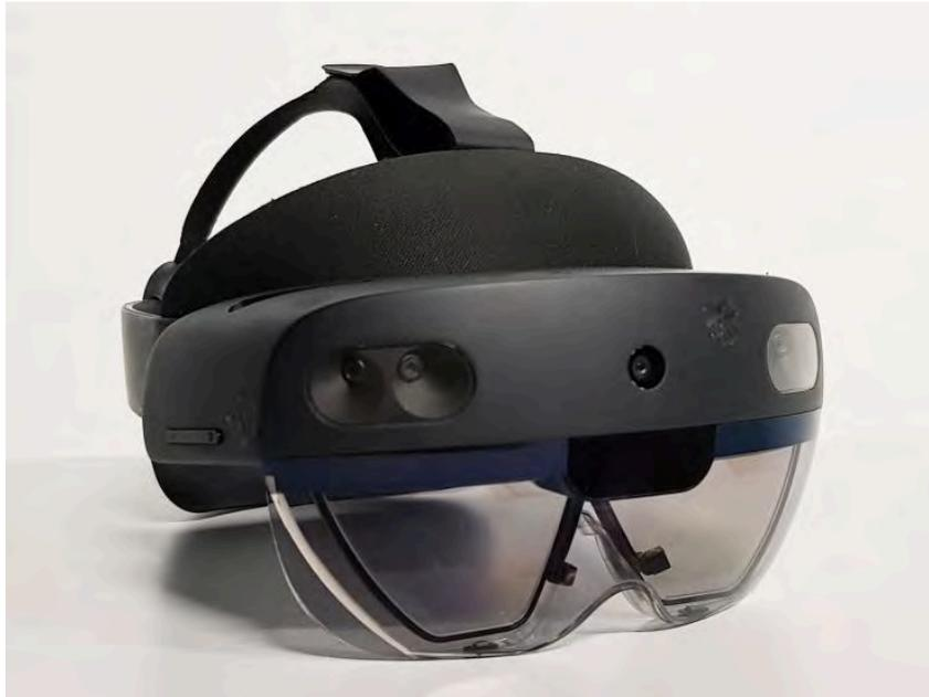
*Note.* Casque de réalité augmentée HoloLens 2, avec une visière, une batterie et un bouton permettant d'allumer et d'éteindre l'appareil. En façade, à gauche et à droite, se trouvent les commandes de luminosité et de volume (CopeLab, 2021).
