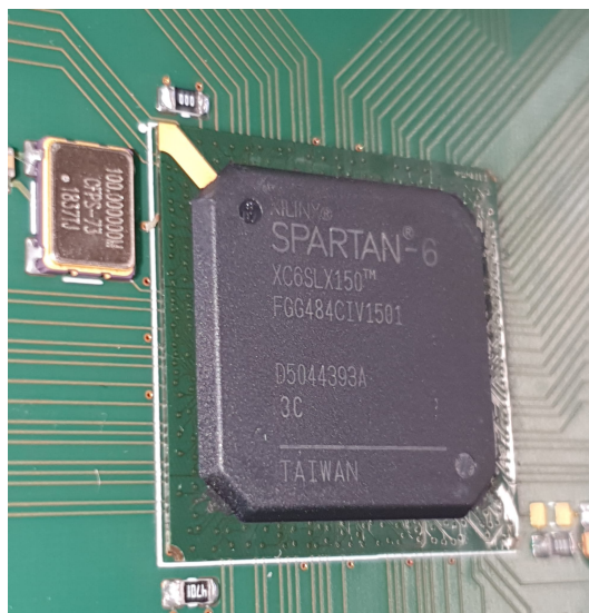
Figure 3.13 FPGA Spartan 6 LX150 en boîtier FGG484 (XC6SLX150-N3FGG484C)
