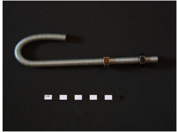
Figure 134 Prototype de crochet pour tube en acier © He-Arc CR, Gaëtan Guillod, 2022.
