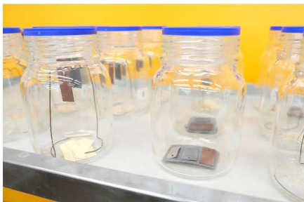
Figure 2 : Support en fil de cuivre avec plaquettes métalliques et plaquettes en contact direct avec l'échantillon.
