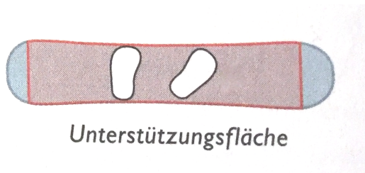
Abbildung 6. Unterstützungsfläche in Rot schraffiert eines Snowboards aus Primus (2007).
