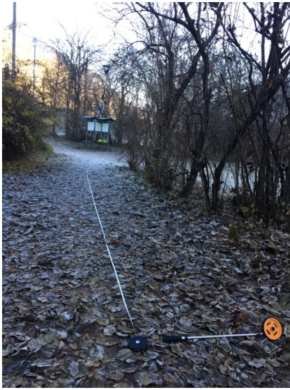
Abbildung 29. Abmessen der Schnitzelbahn in Brig mit Rollrad und Messband.
