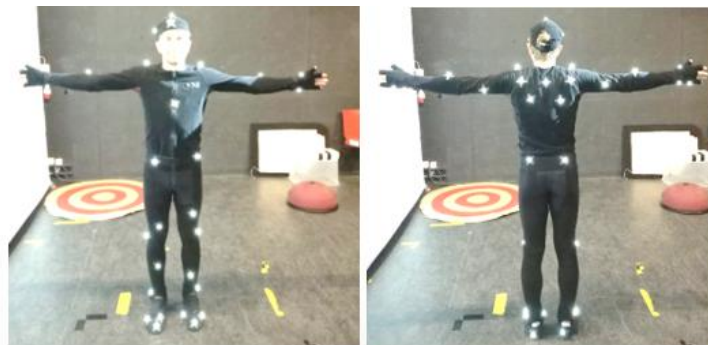
Figure 7. Sujet en position T avec 41 capteurs répartis sur le corps.
