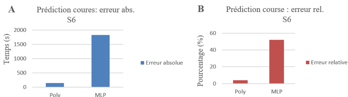
Figure 11. Comparaison des erreurs. A: Erreur absolue des régressions MLP et polynomial pour la prédiction de course pour le sujet S6. B: Erreur relative des régressions MLP et polynomial pour la prédiction de course pour le sujet S6.
