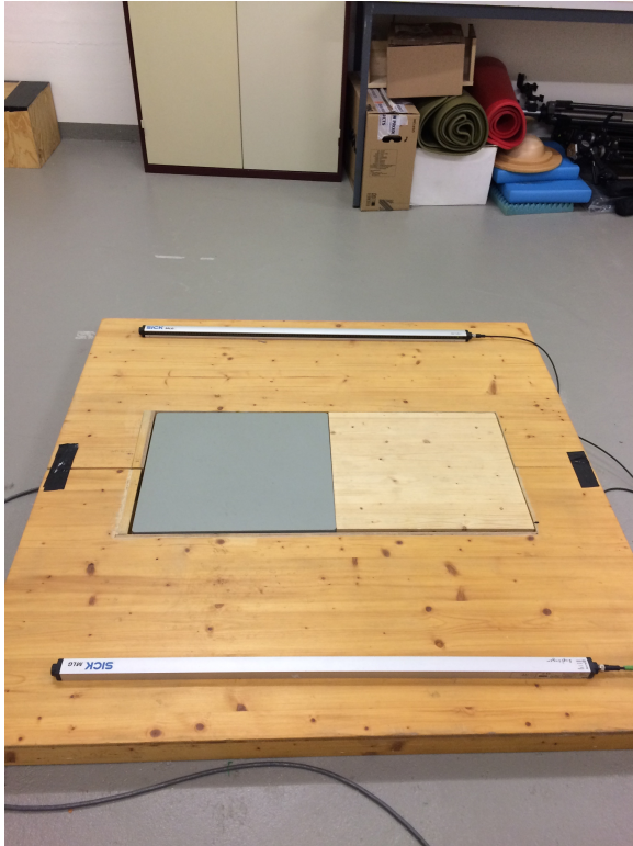
Abbildung 4. Versuchsanordnung der Kraftmessplatte OR 6-7.
