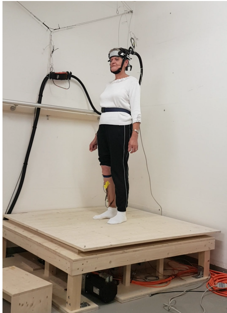
Figure 2. Illustration d'un sujet positionné sur la plateforme qui provoque des perturbations. Le sujet est muni d'un casque accroché à la bobine de la TMS. Deux électrodes sont placées sur le SOL, le TA et le GM.
