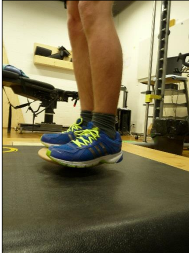
Abb. 6 : Holzkreisel auf der Kraftmessplatte
