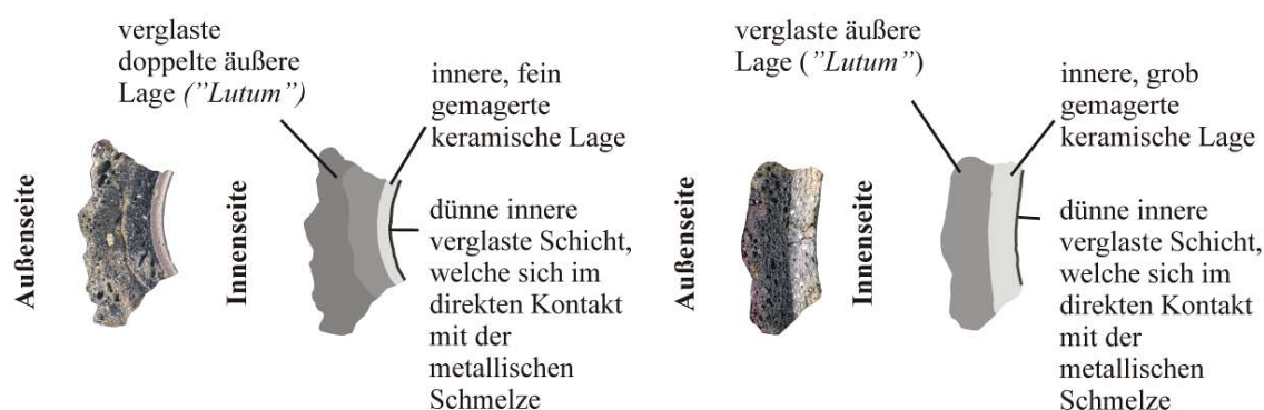
Abbildung A1-5. Aventicum. Querschnitt durch einen fein gemagerten Schmelztiegel (links) mit doppelter äußerer Lage (MRA 67/5437[1]) und einen grob gemagerten Schmelztiegel (rechts) mit einfacher äußerer Lage (MRA 68/1215). Maßstab ca. 1:2.
