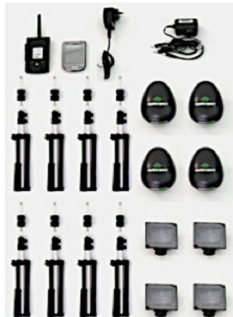
Abb. 8: Instrumentenübersicht der Lichtschrankenmessung beim Eingangs- und Ausgangstest (Smartspeed™, 2013).
