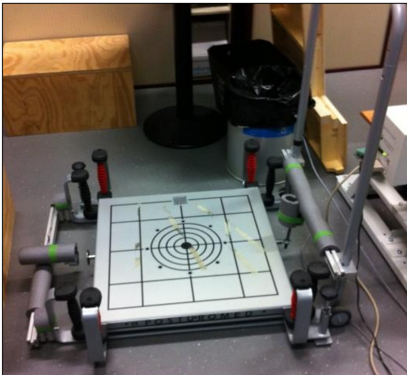
Abb. 12: Posturomed (Haider Bioswing, Pullenreuth, Germany) zur Erfassung der einbeinigen Standstabilität.
