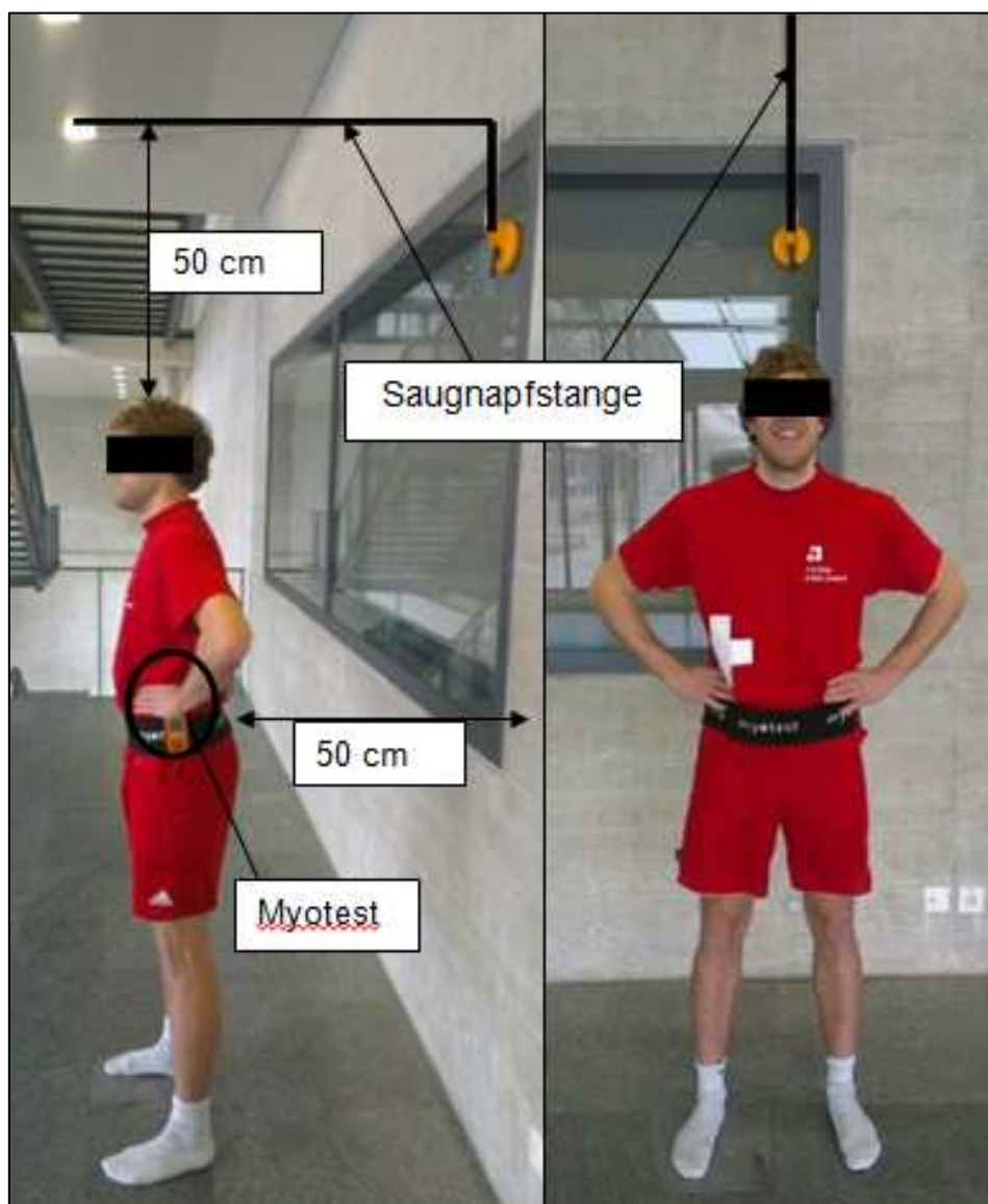
Abb. 8 Mobiles Testdesign mit Myotest, Saugnapfkonstruktion und Proband
