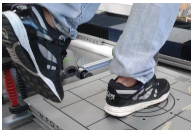
Abb. 11: Messung des Gleichgewichts mit Hilfe der multi-axialen Plattform (Posturomed) während 15 Sekunden.
