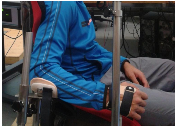
Abb. 16: Handgelenksschiene mit Verbindung zum Kraftaufnehmer. So kann die Abweichung der Ist - Kurve von der Soll-Kurve (in Volt) erfasst werden.
