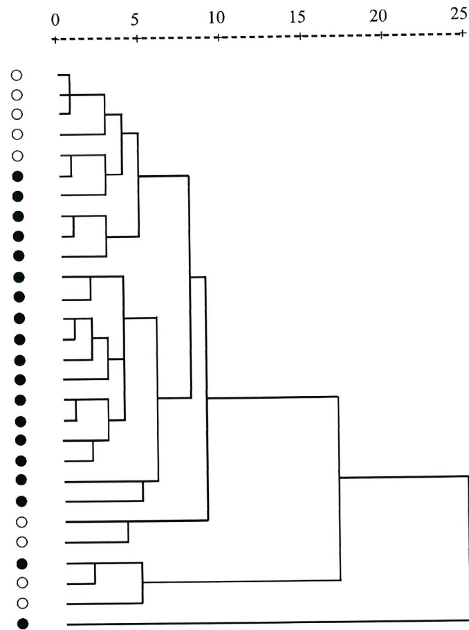
Abb. 10. Dendrogramm einer Clusteranalyse der Fayence-Referenzgruppe Nevers 17. Jh. (Punkte, n = 19 ) mit neun sog. Le Croisic Fayencen (Kreise). In einem solchen Dendrogramm, das zur Veranschaulichung einer hierarchischen Clusteranalyse dient, gruppieren sich die Untersuchungsobjekte nach ihrer chemischen Ähnlichkeit zu Gruppen bzw. Clustern. Je früher sich die Objekte bzw. die Cluster vereinigen, desto ähnlicher sind sie. 0-25 = skalierte Abstände zwischen den Clustern. Die Le Croisic Fayencen gruppieren sich zwar mehrheitlich außerhalb der Referenzgruppe, aber da sie kleinere Distanzen als die marginalste, echte Nevers Fayence aufweisen, stammen sie aus dieser Produktion und nicht aus Le Croisic. Umzeichnung aus Rosen et al. (2007a; SPSS, average linkage, between groups, squared euclidean distance, not standardized data, 18 oxydes resp. elements used).
